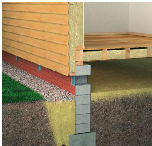
Ocieplenie podłogi parteru nad przestrzenią wentylowaną Ocieplenie ścian w konstrukcji szkieletowej
