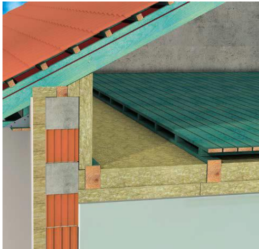
Ocieplenie poddasza nieużytkowego na stropie belkowym
