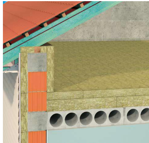
Ocieplenie poddasza nieużytkowego na stropie masywnym
