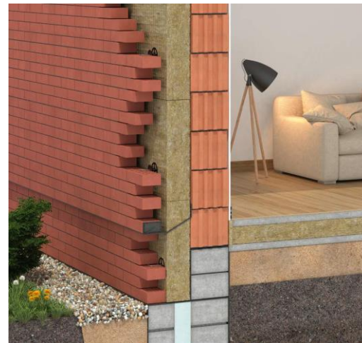
Ocieplenie ściany trójwarstwowej
