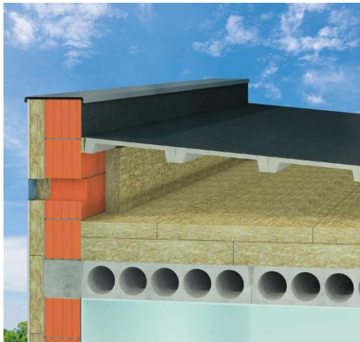
Ocieplenie dwudzielnego stropodachu wentylowanego o konstrukcji masywnej
